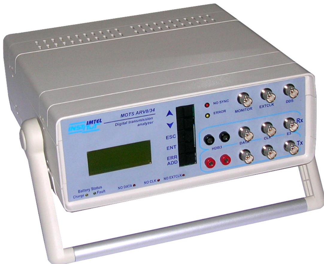
Instrument za merenje kvaliteta prenosa signala MOTS ARV8/34 (AR↔Any rate, V↔V.35) namenjen je za testiranje kvaliteta prenosa na nivou stepena greške u digitalnim telekomunikacionim sistemima kapaciteta sa interfejsom za HDB3 kod na nivou 2.048 Mbit/s, 8.448 Mbit/s, 34.368 Mbit/s sa uobličavanjem signala po preporuci **ITU-T-G.703**. Takođe uređaj MOTS ARV8/34 je namenjen za testiranje druge telekomunikacione opreme protoka do 10Mbit/s sa interfejsom tipa **takt+podaci**.
